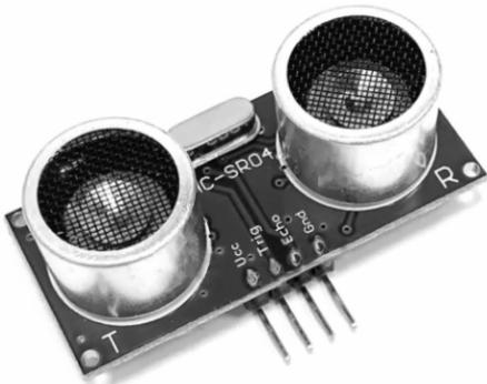
图 5-18 HC-SR04 超声波测距模块
